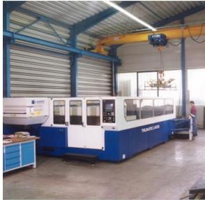
**Laserschneidanlage Trumpf Trumatic L4050**
